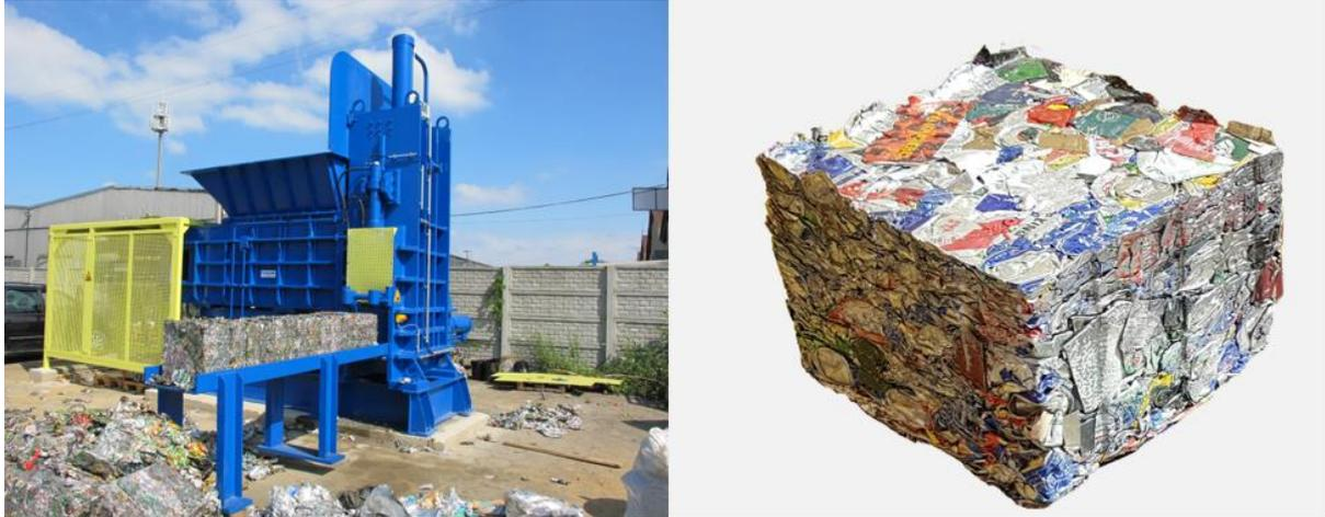
Abbildung 7: Paketierpresse von ATM Recyclingsystems und Ergebnis der Dosenpaketierung
